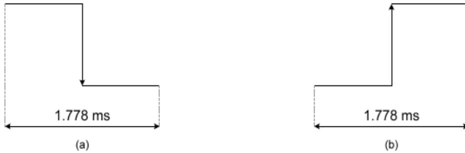
Fig. 3.3.1.1 Codifica del bit 0 (a) e del bit 1 (b)
